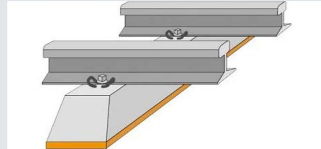
Die elastische Schicht unterhalb der Schwelle führt zu einer verminderten Erschütterungsanregung. Die Wirkung der Maßnahme ist dabei abhängig von den relevanten Frequenzen der Erschütterungen. Bei der Auslegung der Maßnahmen ist daher vorab in einer **Prognoseberechnung** zu prüfen, ob im betrachteten Fall eine ausreichende Wirkung erwartet werden kann. Weiterhin sind **Kosten-Nutzen-Betrachtungen** durchzuführen.
